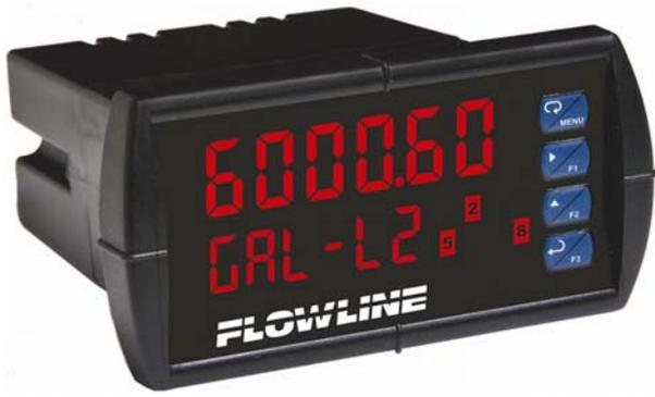
此款通用型液位控制器采用 1 路 4-20 mA 或 0-10 VDC 液位传感器连续输入，以工程单位显示数值，提供三种不同配置，可选择 2 路或 4 路可编程继电器，或配置隔离式 4-20 mA 中继器。针对单工（单泵或单阀）或双工（双泵）液位控制模式下自动进液或排液，每一继电器均可配置单设定值（高液位报警或低液位报警）或自锁双设定值。
